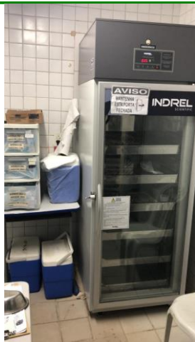
33.17. Refrigerador para vacinas, munido de termômetro externo específico
