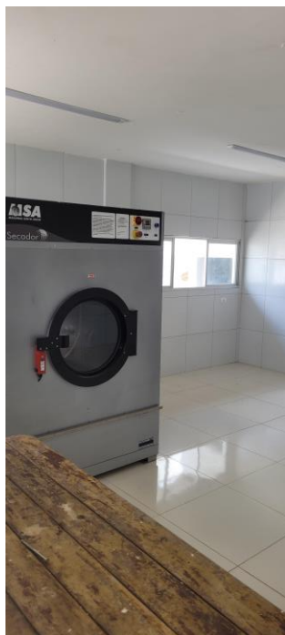
28.20. Secadora na Lavanderia que NÃO conta com centrífuga/ separação entre secos e úmidos
