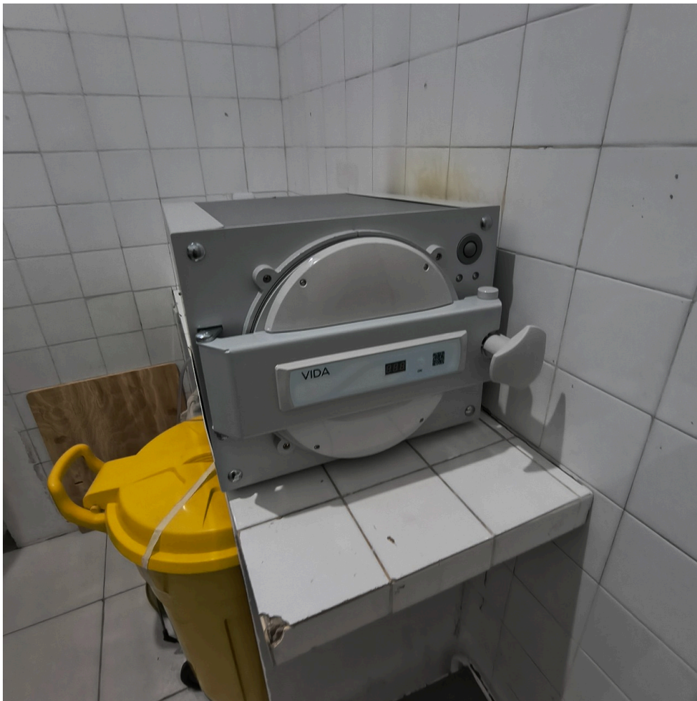
centro de material esterilizado - CME conta com autoclave de 12 litros SEM fluxos unidirecionais de pessoas e materiais
