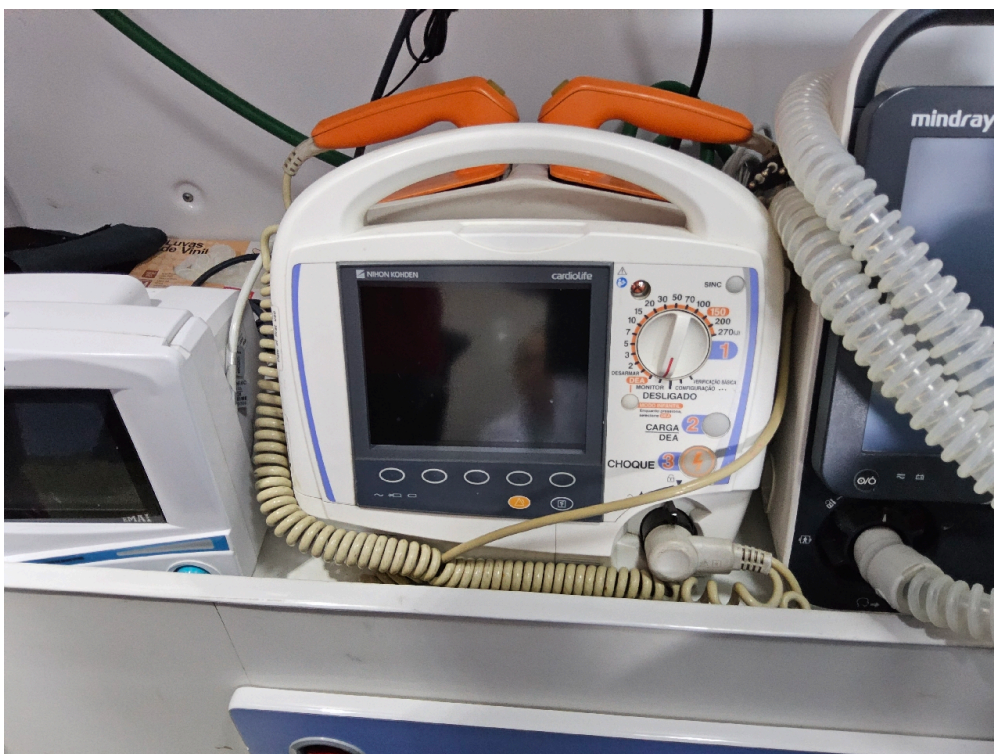
TIPO D: AMBULÂNCIA DE SUPORTE AVANÇADO - Funciona apenas quando ligado na energia. Não funciona na bateria.
