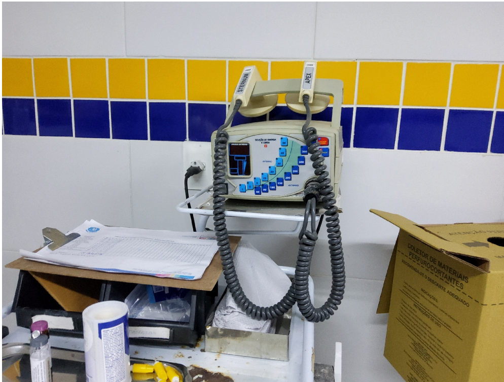
SALA DE REANIMAÇÃO E ESTABILIZAÇÃO DE PACIENTES GRAVES (SALA DE URGÊNCIA, EMERGÊNCIA OU VERMELHA) – ADULTO - Desfibrilador com monitor
